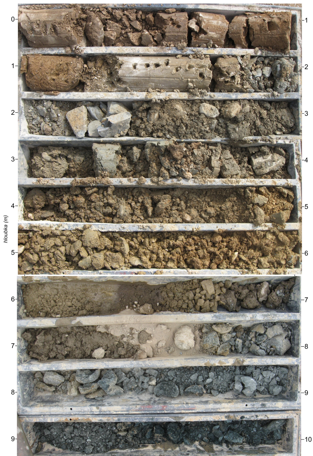
Vrtné jádro S4 (v křehkých a rozpadavých horninách pod hladinou podzemní vody je malý výnos jádra)
